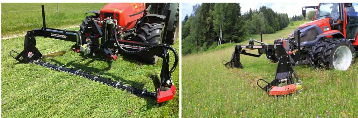
Figure 40 : Exemple de matériels utilisant une barre de coupe à double-lame. © BB Umwelttechnik ( source : <https://doppelmessermähwerk.de/> )
