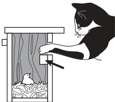
Pour limiter le risque de prédation, disposez un coin en bois à l'intérieur des nichoirs "boîte", sous le trou d'envol.
